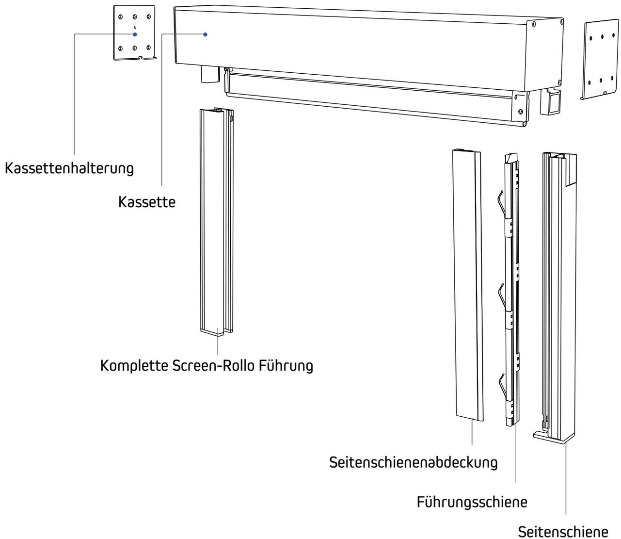
1. Die Screen-Rollo Führung umfasst eine Seitenschiene, eine Seitenschienenabdeckung und eine Führungsschiene.
